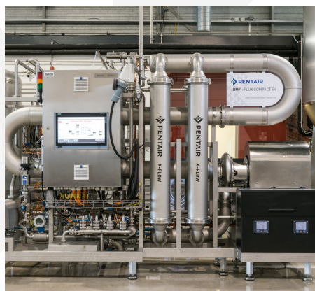
Установка BMF +Flux Compact S4 – производительность 30-60 гл/час
